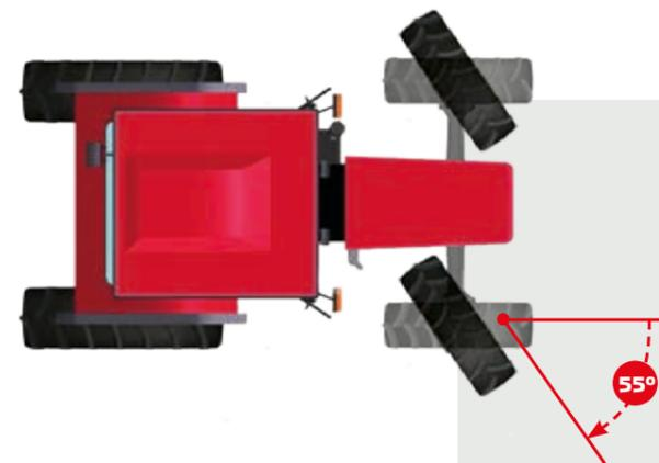
Ampia oscillazione dell'assale, alta luce libera da terra e angolo di sterzo fino a 55° assicurano grande manovrabilità e precisione. Al tempo stesso, la guida idrostatica permette una sterzata dolce anche a bassi regimi. L'assale sospeso consente di raggiungere i 50 km/h.
