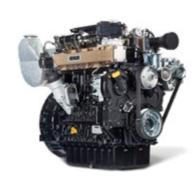
I propulsori Stage 5 utilizzati sono ai vertici della categoria e consentono le migliori prestazioni di coppia e potenza contestualmente a minori consumi, minore rumorosità, minori emissioni di carbonio. Trattasi di un motore Kohler a 4 cilindri (2482cc), con aspirazione turbo ed iniezione Common Rail con la potenza di 75hp a 2300 RPM e coppia massima 310 Nm a 1500 RPM.
