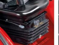
SEDILE PNEUMATICO Molleggio sedile pneumatico a regolazione continua del peso conducente da 50 a 130 Kg e regolazione continua in altezza.
