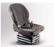
SEDILE COMFORT GRAMMER A sospensione pneumatica con visulizzatore del carico, schienale reclinabile e supporto
