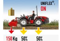
La sospensione *UNIFLEX* \* trasferisce parte del peso dell'attrezzo sulle ruote.
