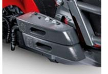
ZAVORRE ANTERIORI Perfettamente integrate nella carrozzeria del trattore, non alterano il passo e l'ingombro del trattore.
